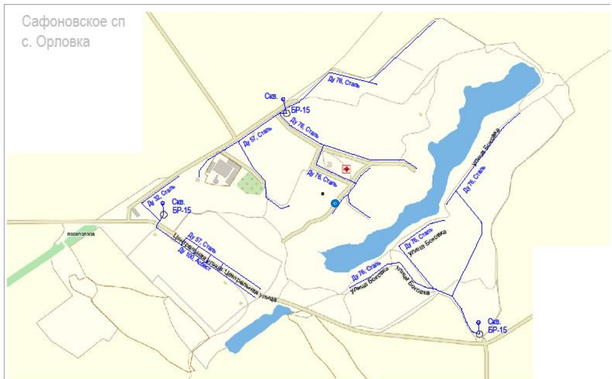
Рисунок 10. Схема сетей водоснабжения в с. Сафоновка
