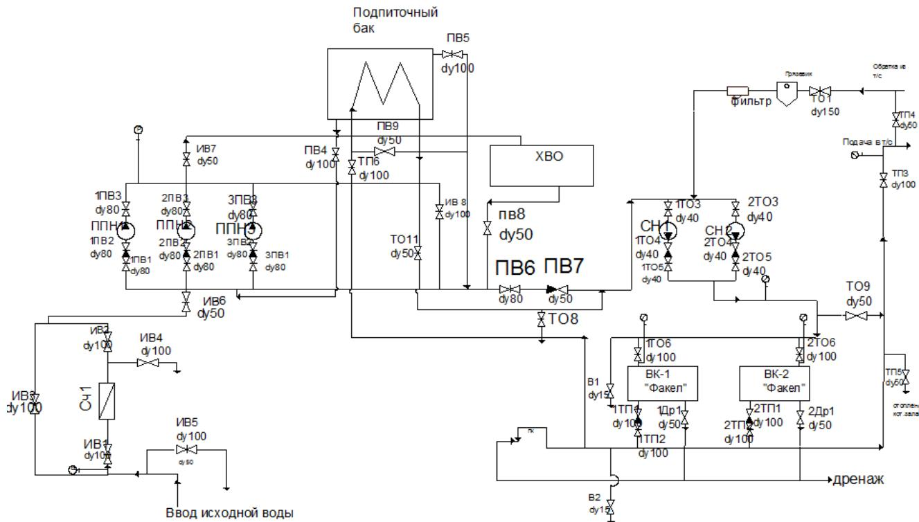
Рис. 3.1 Схема отпуска тепловой энергии котельной с. Драгунка
