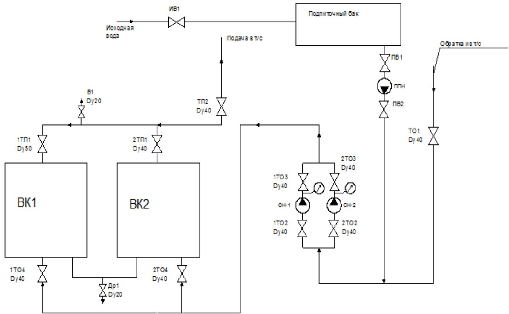
Рисунок 4. Схема отпуска тепловой энергии котельной с. Покровка школа
