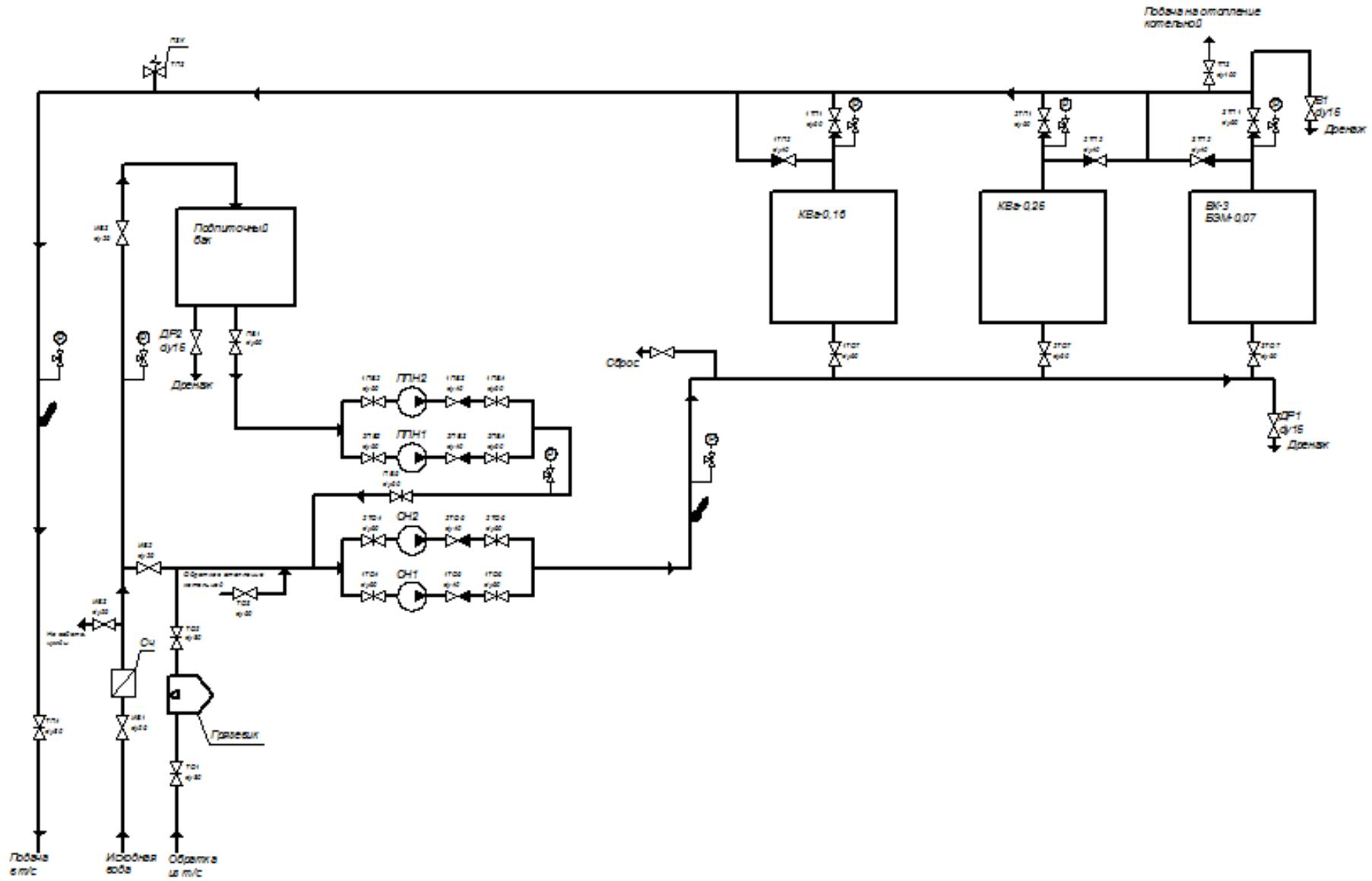
Рисунок 3. Схема отпуска тепловой энергии котельной с. Сафоновка
