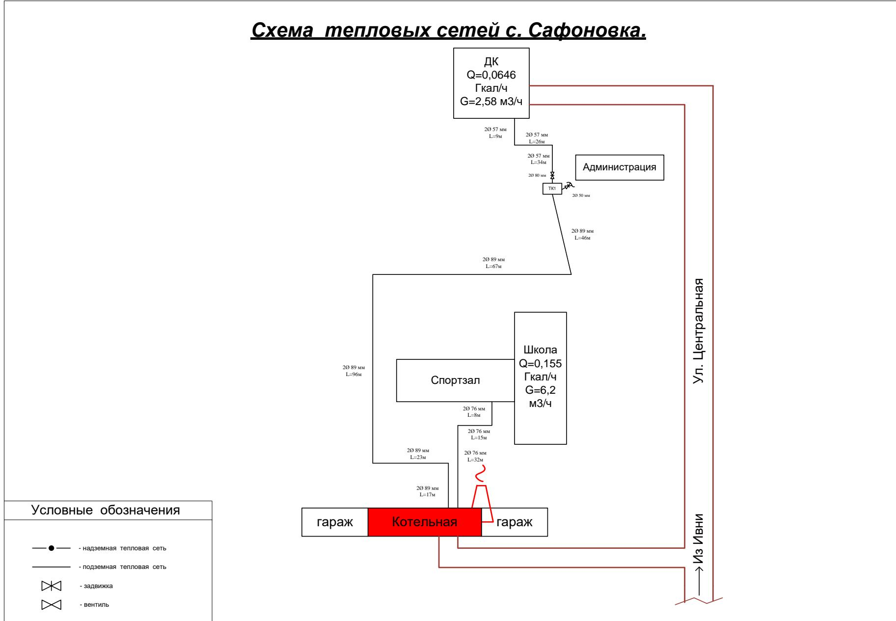
Рисунок 2. Схема тепловых сетей котельной с. Сафоновка
