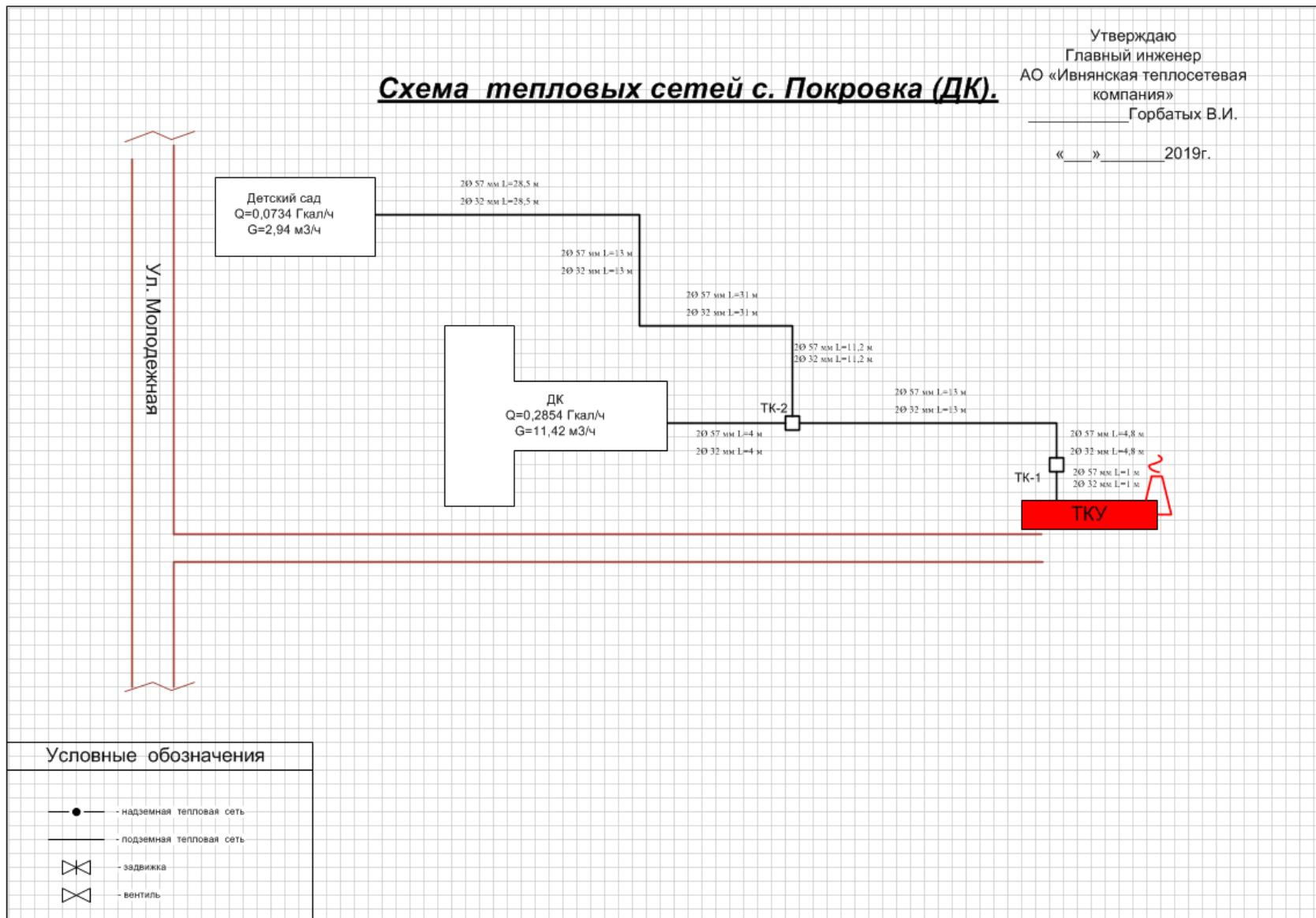
Рисунок 5. Схема тепловых сетей котельной с. Покровка ДК
