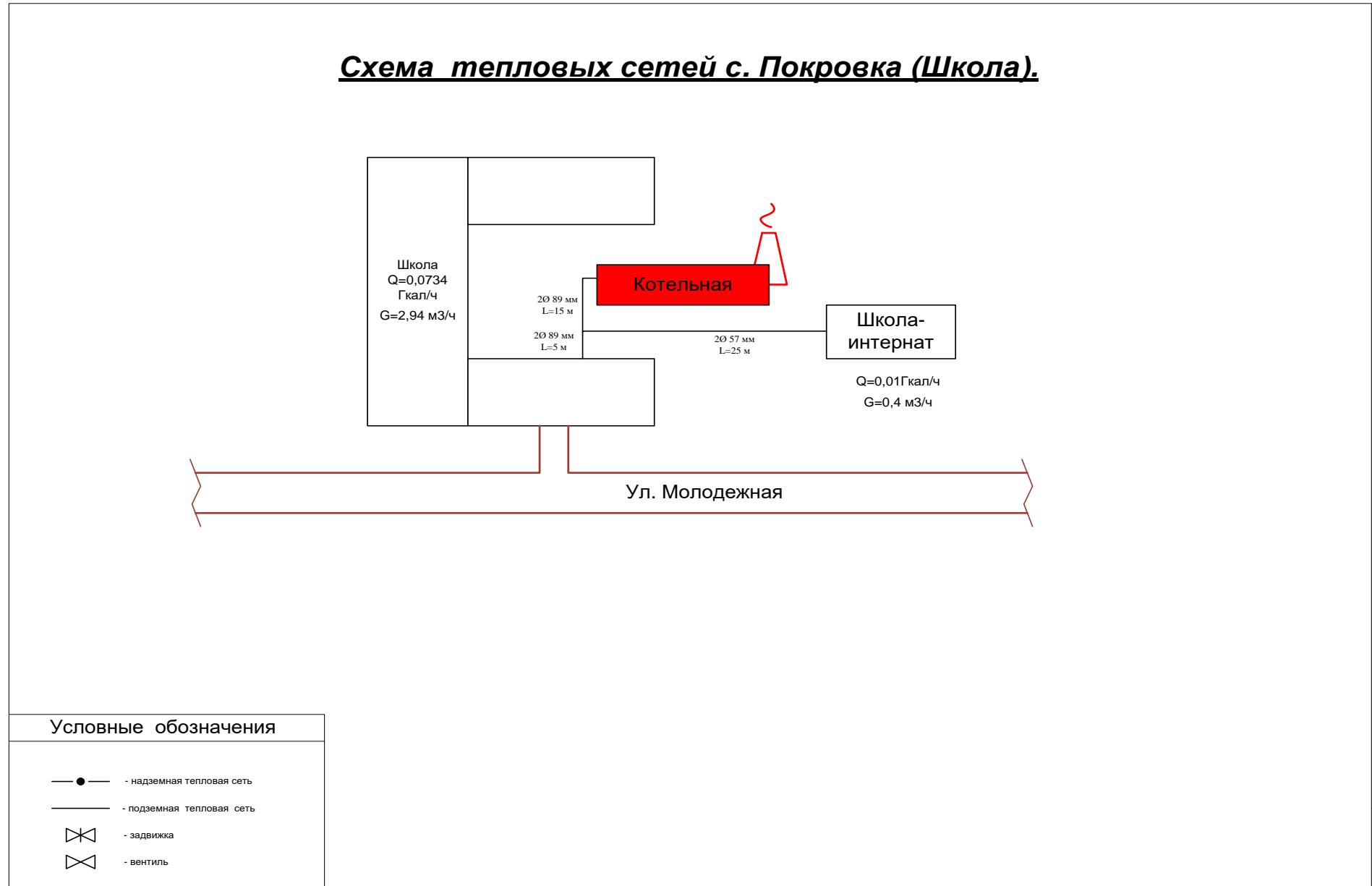
Рисунок 3. Схема тепловых сетей котельной с. Покровка школа
