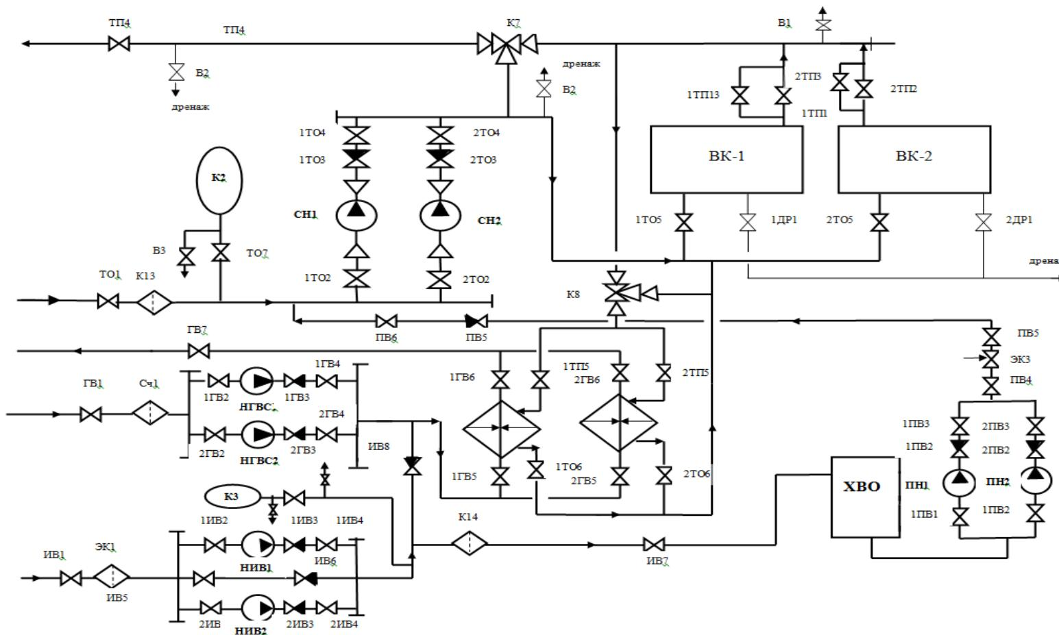
Рисунок 6 Схема отпуска тепловой энергии котельной с. Покровка ДК
