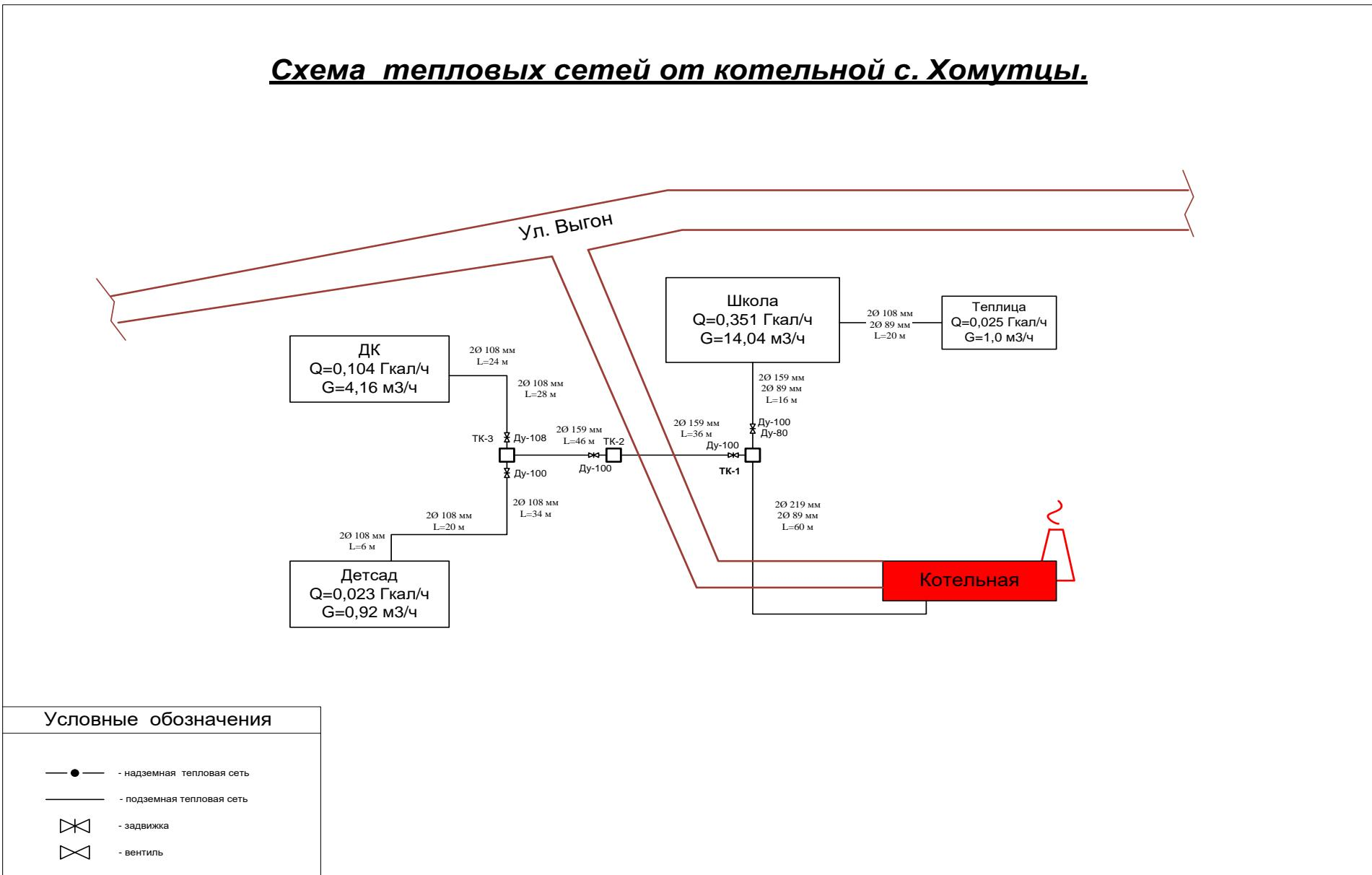
Рисунок 2. Схема тепловых сетей котельной с. Хомутцы
