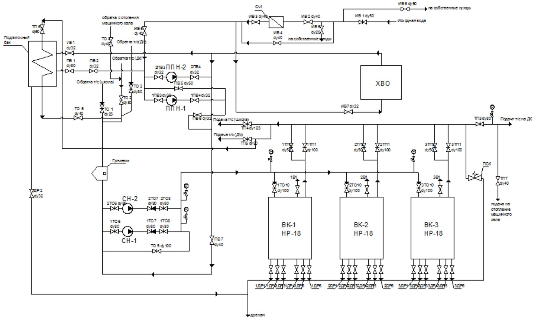
Рисунок 3. Схема отпуска тепловой энергии котельной с. Песчаное
