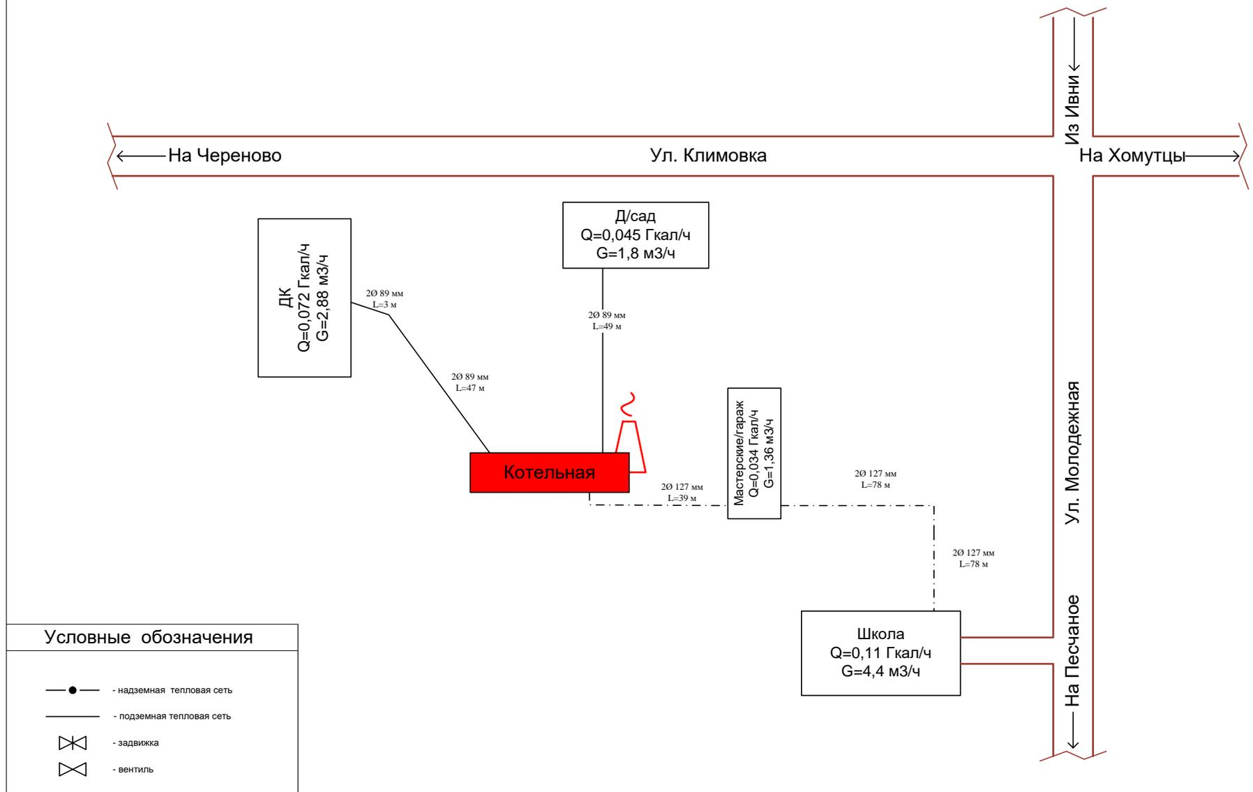
Рисунок 2. Схема тепловых сетей котельной с. Песчаное
