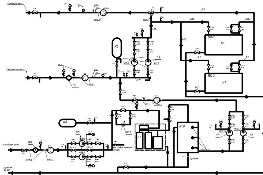
Рисунок 3.1 Схема отпуска тепловой энергии ТКУ-0,2 с. Богатое
