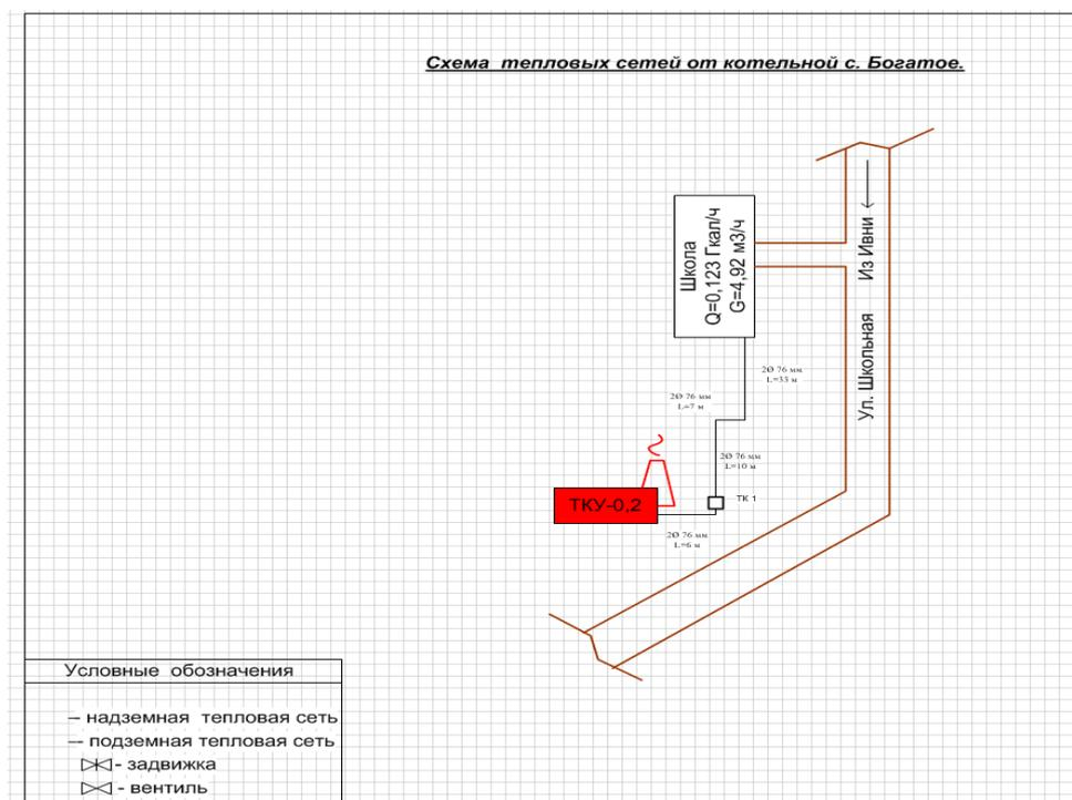
Рисунок 3 Схема тепловых сетей от котельной с.Богатое
