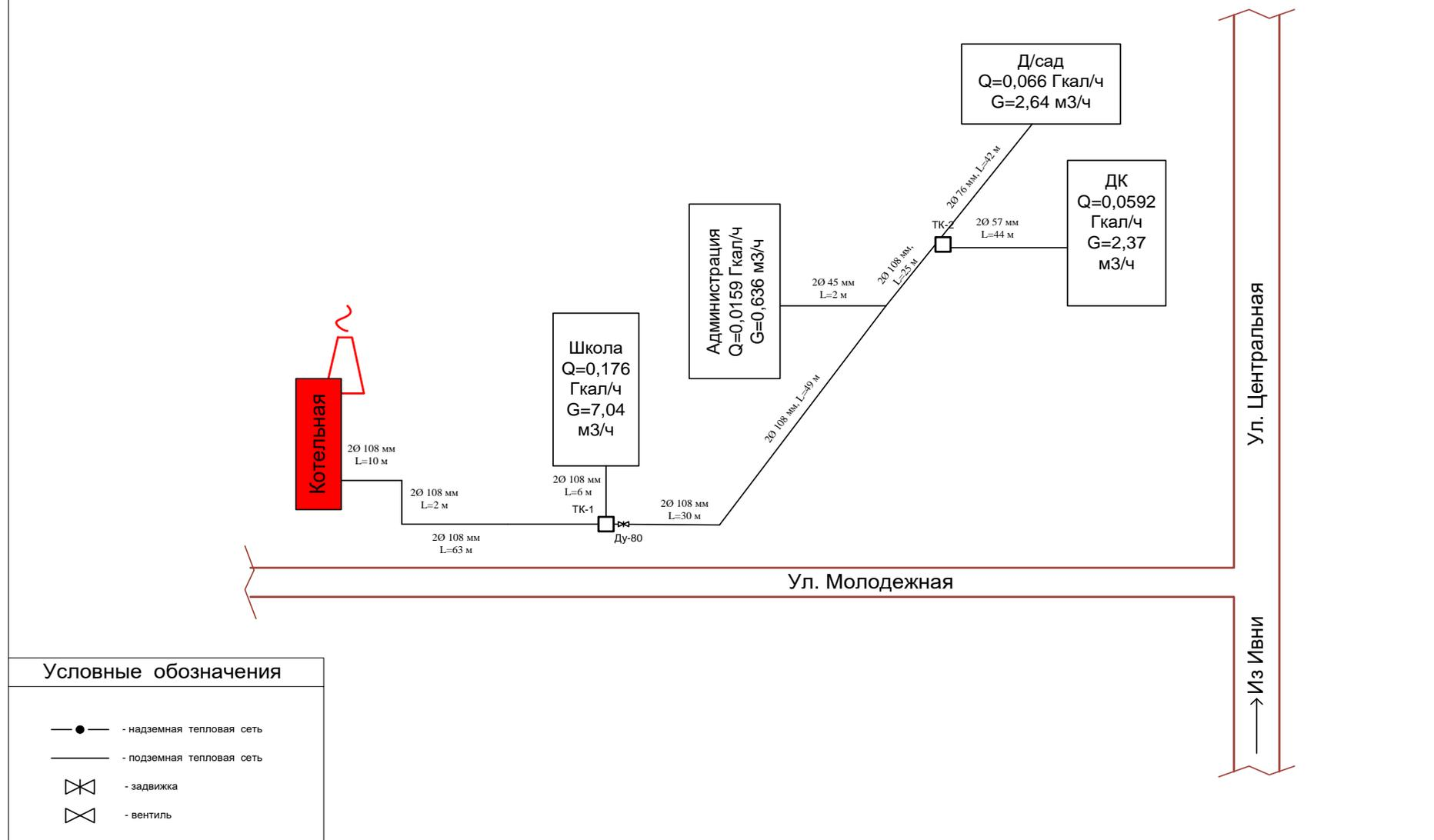
Рисунок 2. Схема тепловых сетей котельной с. Сухосолотино
