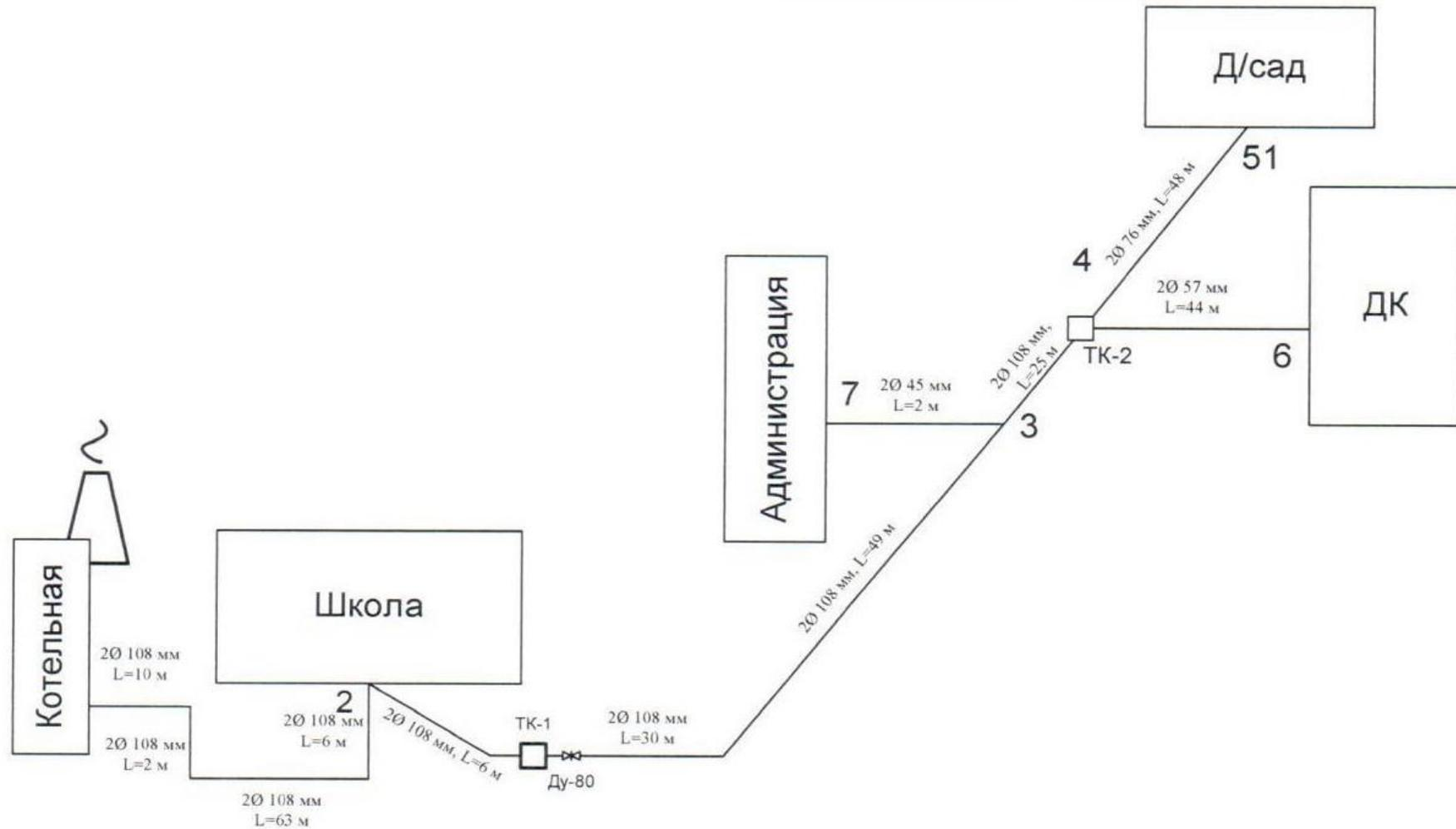
Рисунок 3. Схема отпуски тепловой энергии котельной с. Сухосолотино
