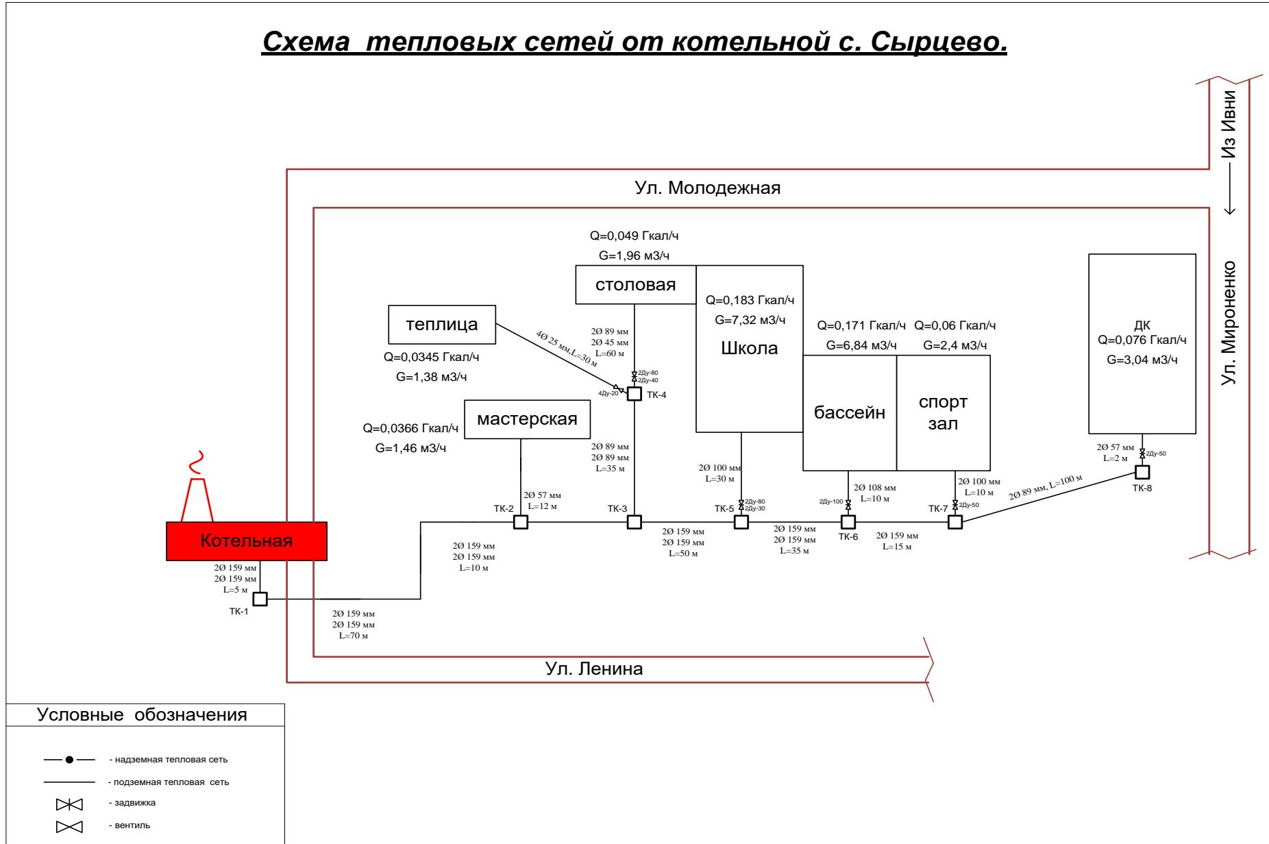
Рисунок 2. Схема тепловых сетей котельной с. Сырцево
