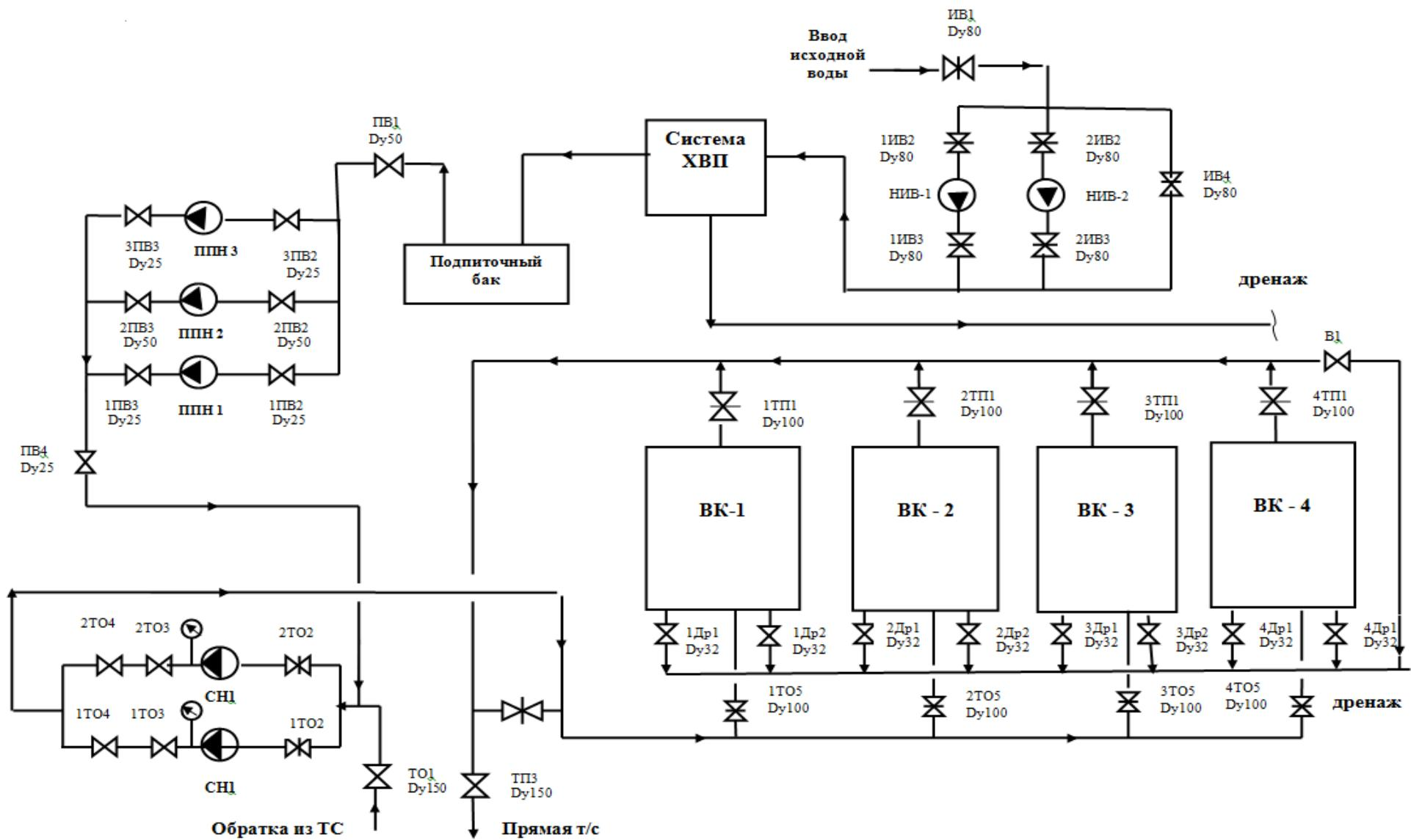
Рисунок 3. Схема отпуска тепловой энергии котельной с. Сырцево
