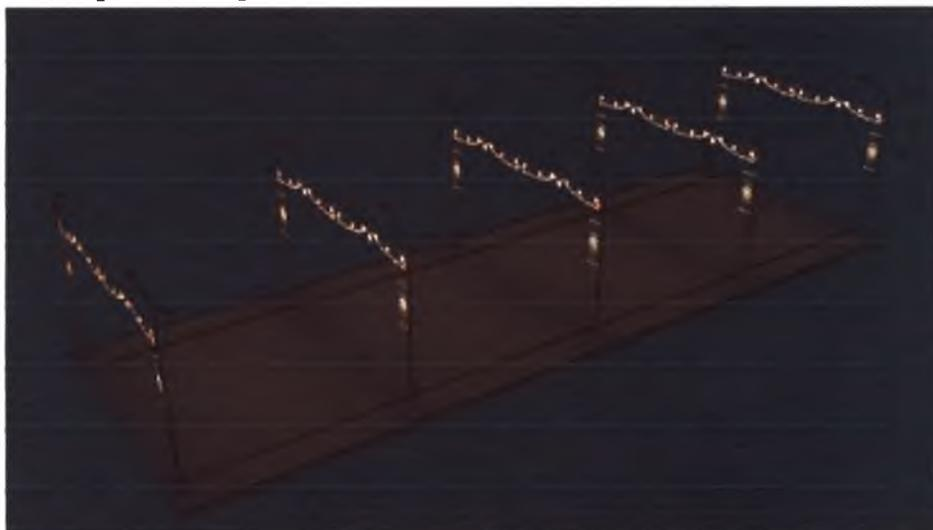
Светодиодные кронштейн-панели в сочетании с применением параллельных гирлянд-перетяжек
