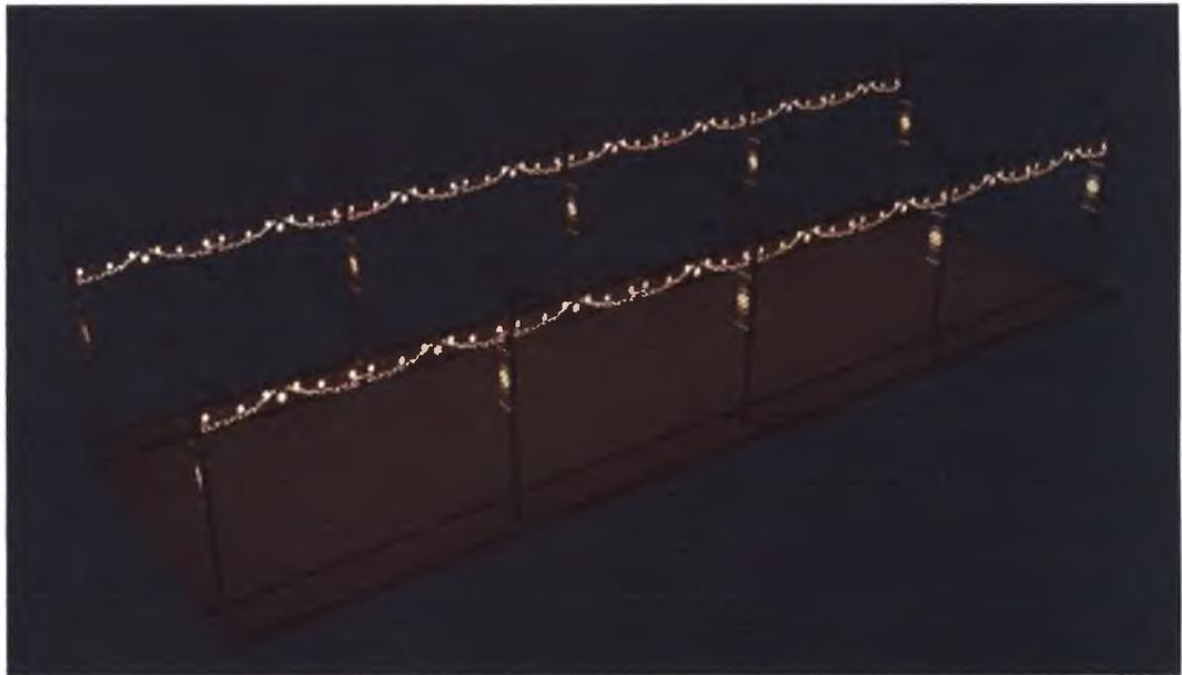
Светодиодные кронштейн-панели в сочетании с применением параллельных гирлянд-перетяжек и поперечных перетяжек с центральным размещением точечных гирлянд с определенным шагом
