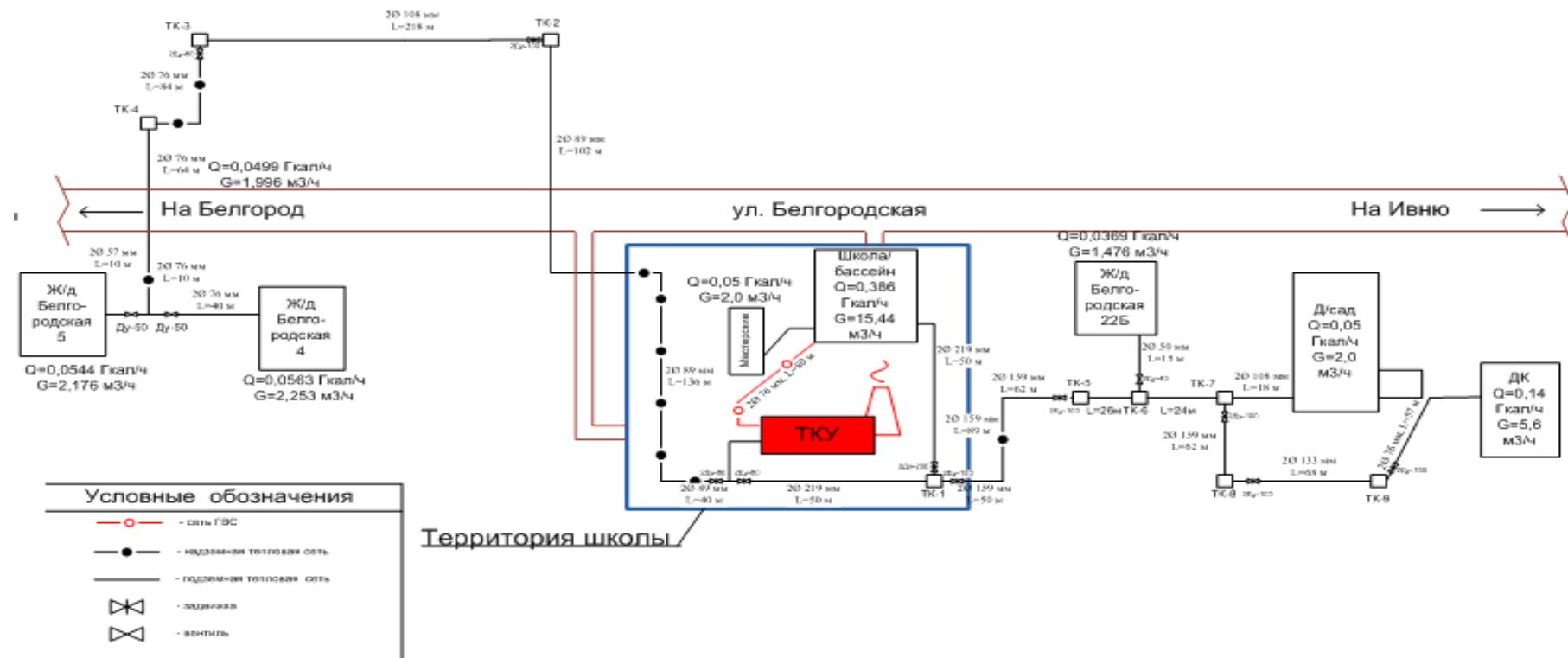
Рисунок 3 Схема тепловых сетей котельной с.Верхопенье
