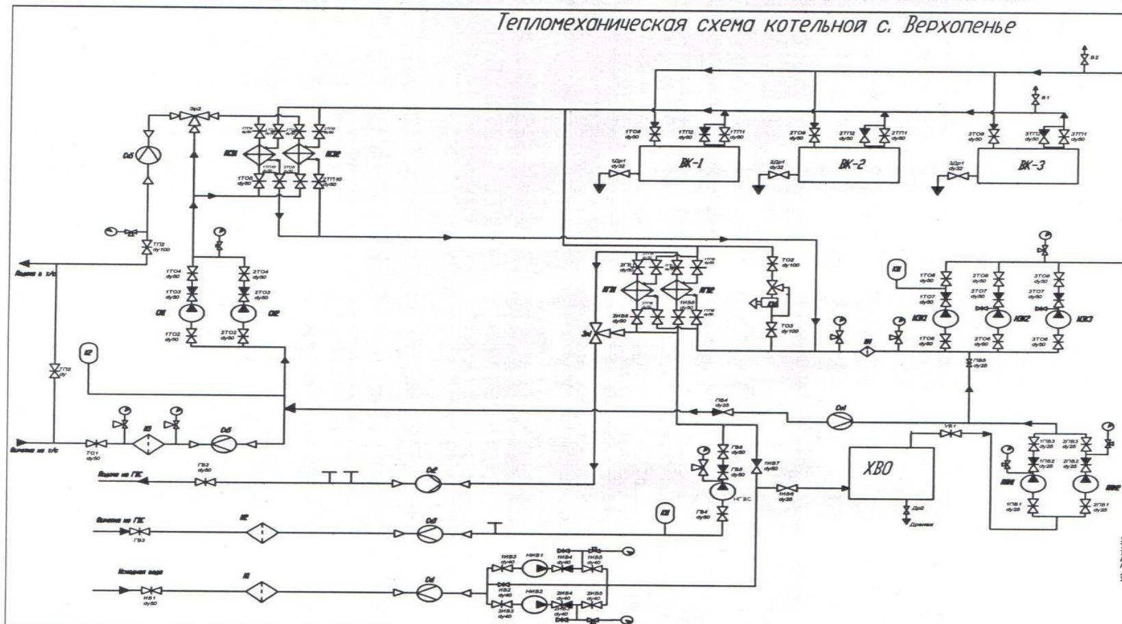
Рис. 3.1 Схема отпуска тепловой энергии котельной с. Верхопенье
